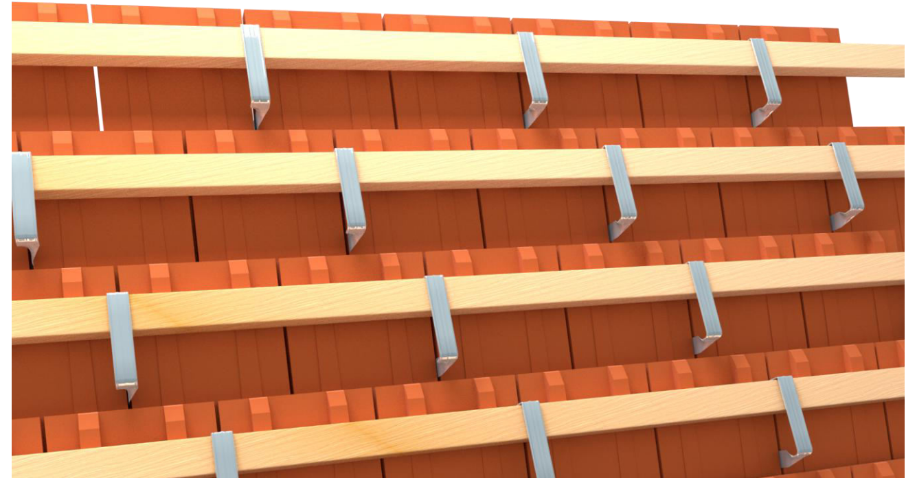
Séma 1:2 beakasztós vihartapocshoz, kettősfedésű hódfarkú cserépfedéshez
