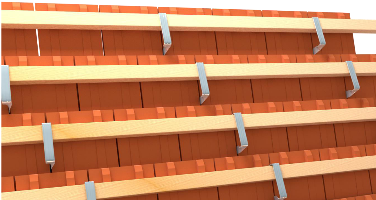
Séma 1:3 beakasztós vihartapocshoz, kettősfedésű hódfarkú cserépfedéshez
