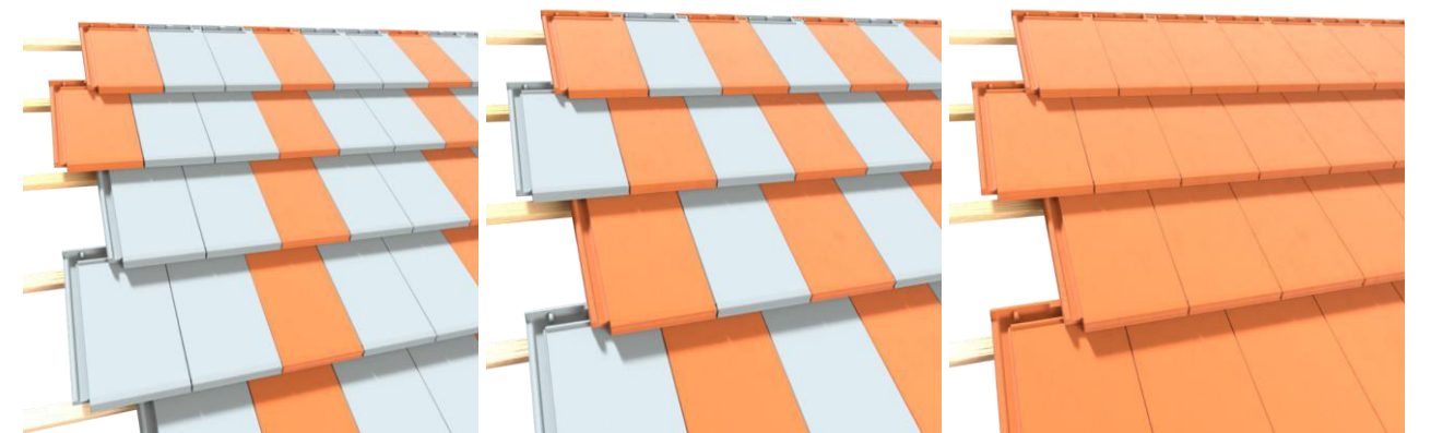
Séma 1:3, séma 1:2 és séma 1:1, a kötésben fedett sajtolt cserépfedéshez
