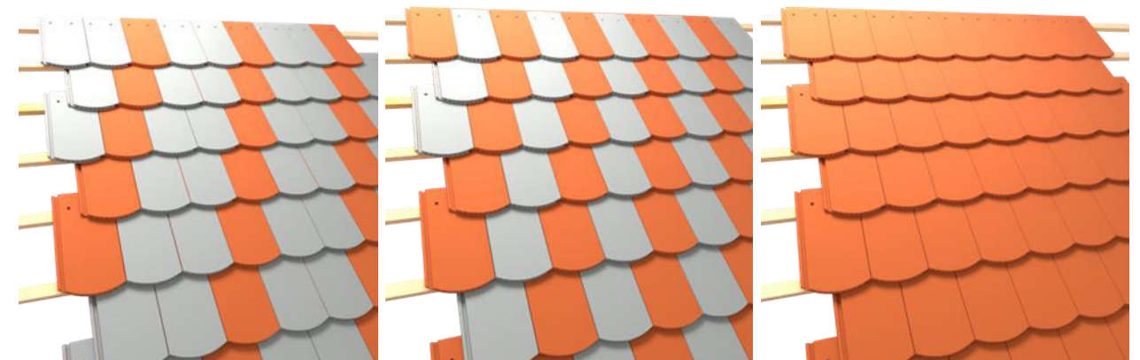
Séma 1:3, séma 1:2 és séma 1:1, a kötésben fedett hornyolt cserépfedéshez
