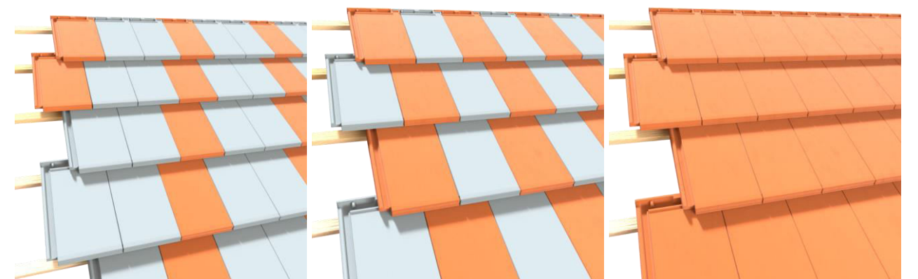
Séma 1:3, séma 1:2 és séma 1:1, a kötésben fedett sajtoló cserépfedéshez
