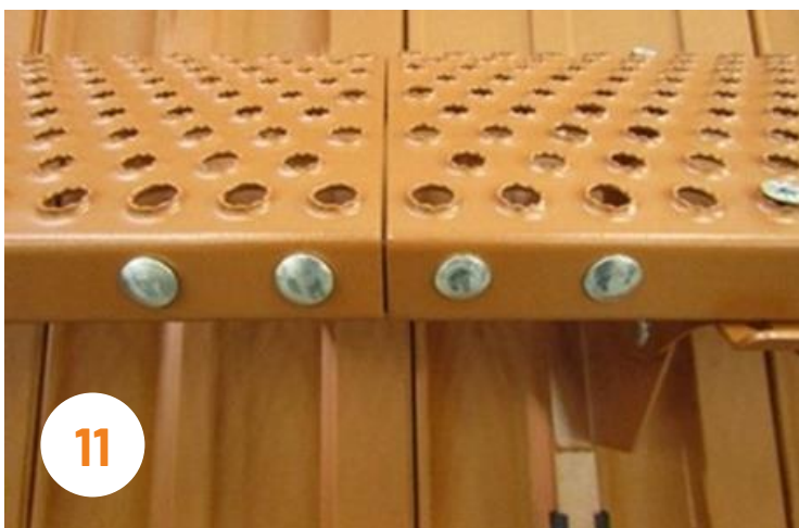
11 A toldókat a rács belső oldalára helyezze és mindkét járórácshoz rögzítse a csomagban található 4-4 db csavarral! Ehhez használjon 13-as csavarkulcsot!
