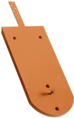
Alumínium alapelem (a cserépmodellhez és színhez illő) a hátoldalon 3 db süllyesztett fejű rozsdamentes acél csavar (5x40 mm A2)
